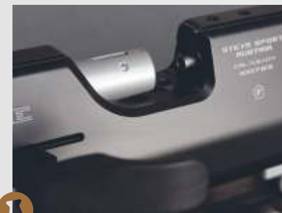
1 Der Laufmantel kann nach Lösen der vorderen Inbusschraube abgenommen werden Allen screw for taking down the barrel tube
