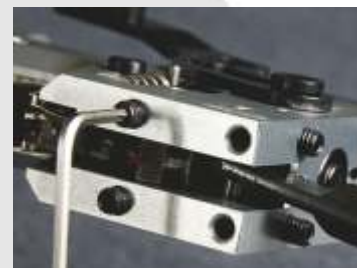
Individuelle Griffeinstellung bleibt bei Griffabnahme erhalten Individual grip adjustment will remain even when grip is removed
