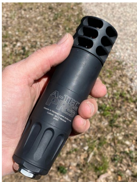
Ensimmäiset tutustumissarjat ammuttiin käyttäen A-Tec:n PRS ammuntaan räätälöityä, kokonaan rosterista valmistettua vaimenninta.
