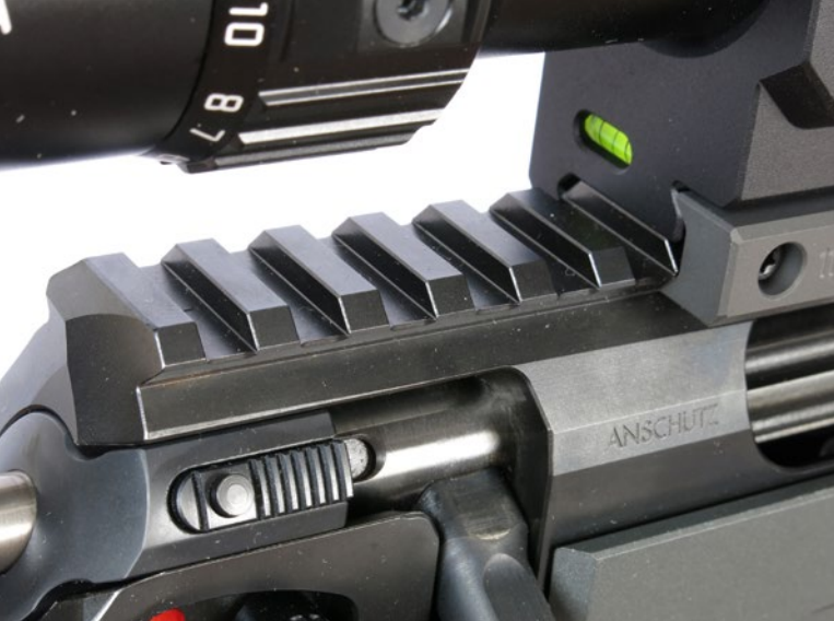
Täysimittainen Picatinny-kisko on jyrstetty suoraan lukonkehukseen ja on kestävästä terästä. Sitä on kallistettu 20 MOA, jotta tähtäimen säätövara riittäisi pitkille matkoille.
