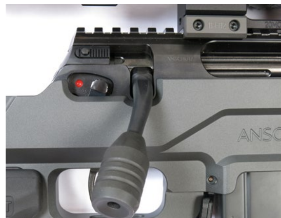
Varmistinta ei paljon kisoissa tarvita, mutta pitkä lukonkampi ja sen suuri nuppi ovat oleellisia nopeissa latauksissa.
