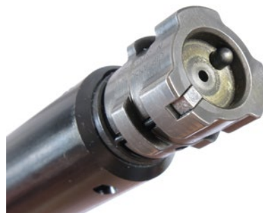
Kaliiperikohtainen 6-olkainen lukonpää on erillinen, lukon runkoon sokattu osa. Tämä yksinkertaistaa tuotantoa ja helpottaa uusien kaliiperien käyttöön-ottoa. Mattamainen harmaa pinta on karkaisun ja harjauksen tulosta.
