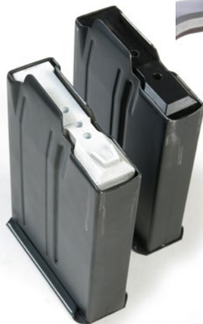
Pienellä patruunan nostimen muutoksella onnistuisi hylsyaukkoon tiputetun patruunan pesityskin ilman, että luoti törmää piipun perään. Ohessa CZ:n sama lipas varustettuna heidän omalla nostimellaan. Vakiolippaalla luodit törmäivät myös CZ:ssä piipun perään.
