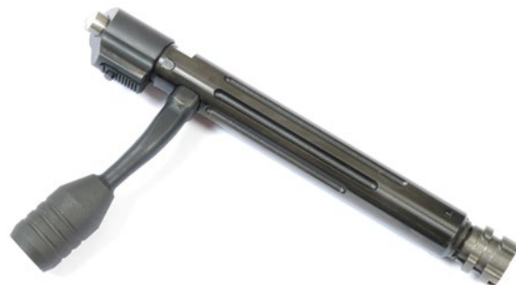
Lukko on tuttu ja testattu vuosikymmenen aikana. Nyt koeammutussa mallissa se on pinnoitettu kovan luistavalla ja korroosiolta suojaavalla DLC (Diamond Like Carbon) kerroksella. Toisena vaihtoehtona on niin ikään erinomaisen kova, liukas ja korroosiolta suojaava keltainen titaaninitridipinnoite.
