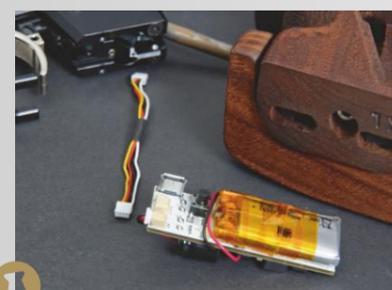
**Kabel beim Elektronikmodul austauschbar (E)**
