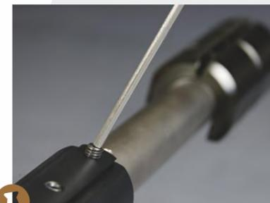
**L** Der Laufmantel kann nach Lösen der vorderen Inbusschraube abgenommen werden
