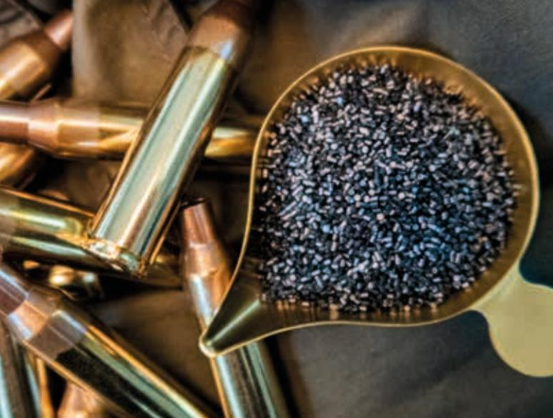
Vihtavuoren N500-sarjan ruudit ovat tehokkaimpia suorituskyvyltään ja soveltuvat tarkoituksiin, joissa raskaille luodeille vaaditaan enemmän nopeutta ja pidempää lentoataa. N500-sarjan ruudit ovat perinteisiä yksikomponenttiruuteja joihin on lisätty nitroglyseriiniä korkeamman energiasällön saavuttamiseksi. Sarjassa on seitsemän erilaista jälleenlatausruutia eri palonopeuksilla.
